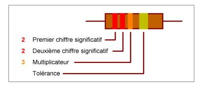
Grâce au tableau précédent, on peut en déduire que cette résistance fait 22000 ohms (chiffre 2 et chiffre 2, suivi de 3 zéros).
